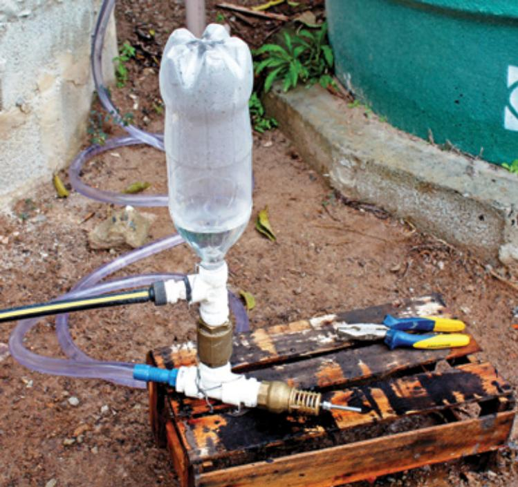
→ **Bomba carneiro hidráulico** - Diferente das bombas convencionais que usam eletricidade, a bomba carneiro usa a pressão do ar para bombear a água do reservatório inferior para caixa d'água superior, o que garante 100% de economia de energia elétrica nessa operação. A iniciativa é pioneira nas obras da construtora.
